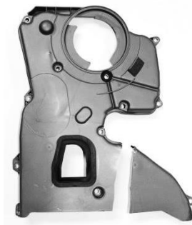
Fracturas o fisuras en las tapas de plástico debido a la degradación del material y/o longevidad del mismo.
